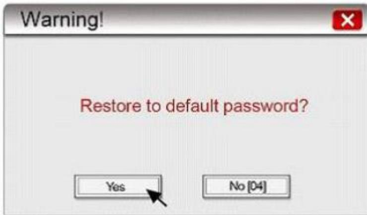
如果要进行系统初始化，按下“YES”，系统再次确认是否要将 HMI 的系统设定密码恢复为出厂设置。当输入[yes]按下[OK]后，HMI 内所有的工程文件、历史资料、密码将全部被清除。
